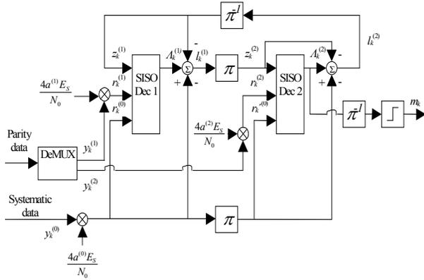
Fig. 3. PCCC turbo decoder
